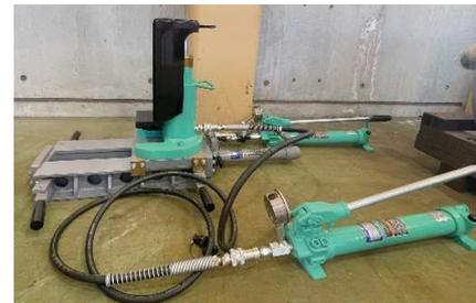
100kN215st 横送り装置付油圧ジャッキ
