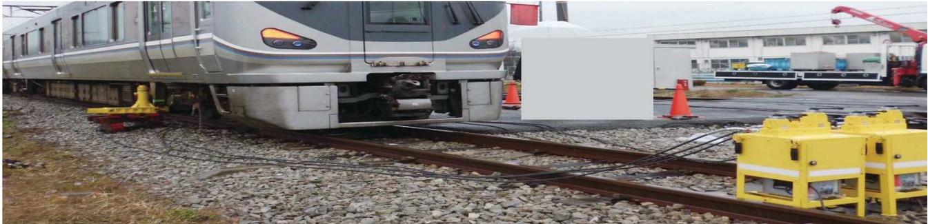
製品は、車輛重量に合わせた各種サイズ、又、昨今の低床車両等にも対応可能です。様々な鉄道会社にて御採用頂いた実績のある製品となります。使用するポンプは電力等の外部動力不要な手動ポンプや、作業を簡易に行える電動ポンプ等、ユーザー様に合わせた仕様にて御用意できます
